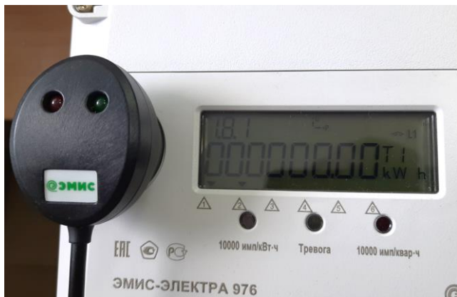
Рисунок 1 – Установка оптической головки на счетчике
